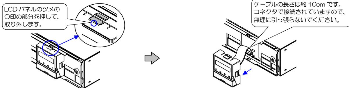
⑤ LCD パネルを横向きにして取り付けます。
