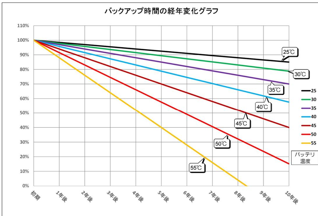
バッテリー初期値、定格負荷時のバックアップ時間を100%とした場合のバックアップ時間の変化を示します。
