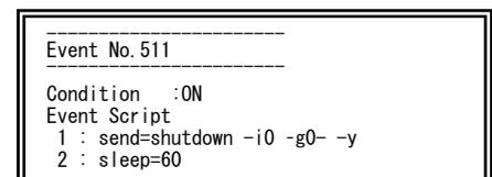
⑧ 「7.3.4.2 シャットダウンスクリプトの実行テストをする」手順①に進み、シャットダウンの実行テストをします。
