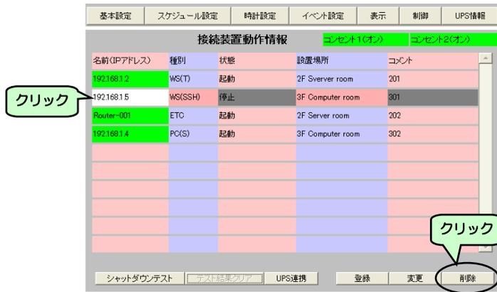
① メイン画面の登録装置一覧から、情報削除する装置を選択します。
