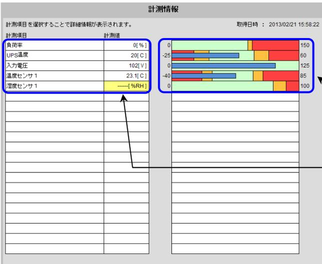
「5.7 計測管理情報の設定」で設定した計測値逸脱監視の設定状態と計測値がグラフで表示されます。グラフの詳細は、次ページをご覧ください。
