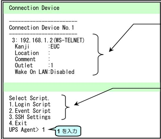
手順②で入力した番号 Connection Device No.に登録されている装置の情報が表示されます。この装置に対してスクリプトを設定します。
