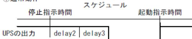
②停電待機時間(delay2)とUPS停止時間(delay3)による停止が起動指示より後の場合
