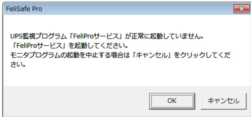
FeliSafe Pro モニタを「管理者として実行」で起動すると自動的に UPS 監視プログラムも起動します。この方法で UPS 監視プログラムが起動しない場合は《4.1. OS の「サービス」によるマネージャの起動、停止方法》の方法で起動してください。
