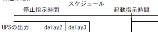
②停電待機時間 (delay2) とUPS停止時間 (delay3) による停止が起動指示より後の場合
