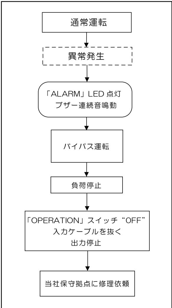
① 以下のような重故障が発生した場合、「ALARM」LEDが点灯し、ブザーが連続鳴動します。また、「DIP」スイッチの設定により、バイパスが禁止されていなければ商用直送給電（バイパス運転）に切り替わります。
