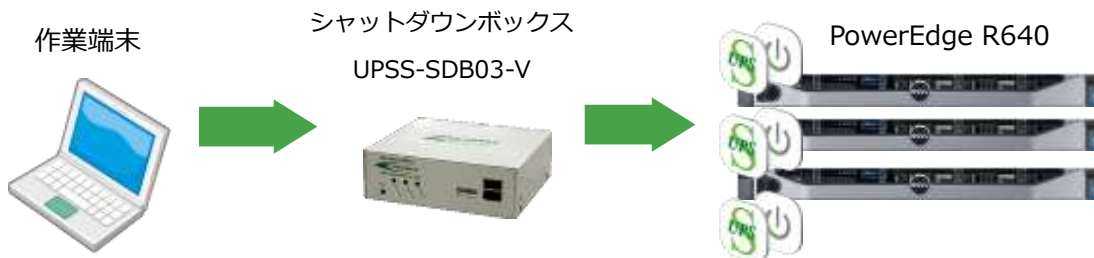
図 5-1. シャットダウンボックス SDB03 検証システム構成
