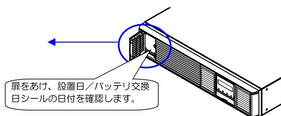
② ①で確認した年月日から、次回のバッテリ交換時期を判定します。
