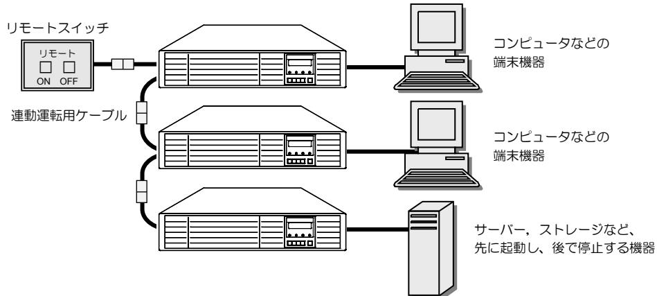
下図は3台のUPSにON遅延、OFF遅延時間を設定して連動運転をした場合の例です。リモートON/OFF操作により、UPSの出力は図のように動作します。インターフェースの設定値によりOFF操作をした場合の動作が異なります。
