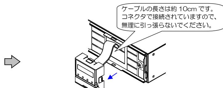
⑤ LCDパネルを横向きにして取り付けます。
