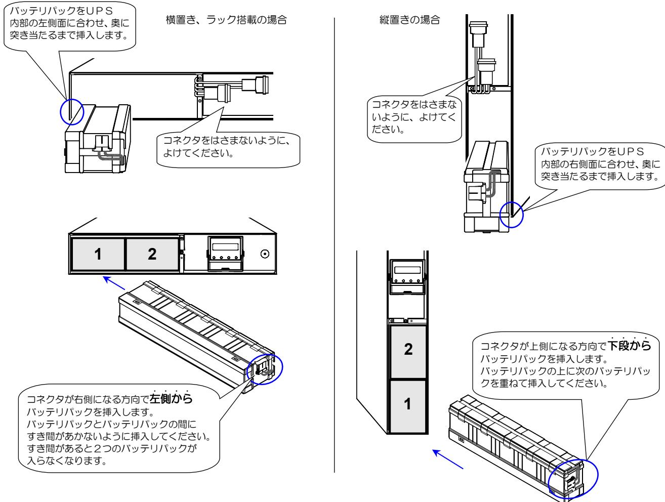
すべてのバッテリパックを搭載してからコネクタを接続します。
