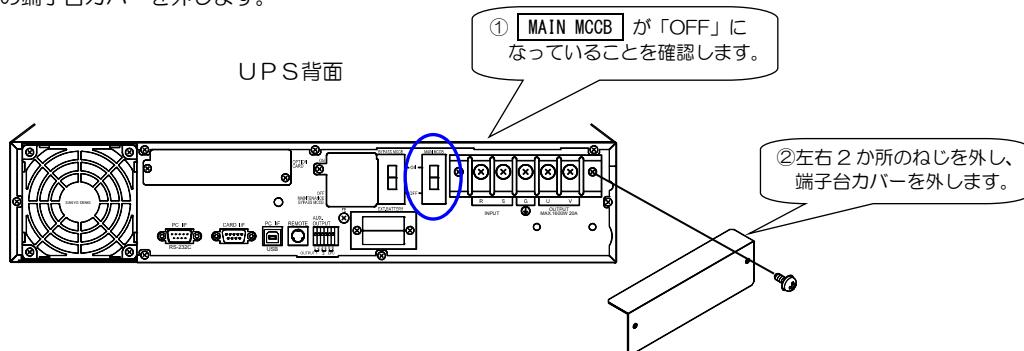
③ 入力電源のアースおよび負荷機器のアースを「INPUT G」端子に接続します。アースはD種接地としてください。
