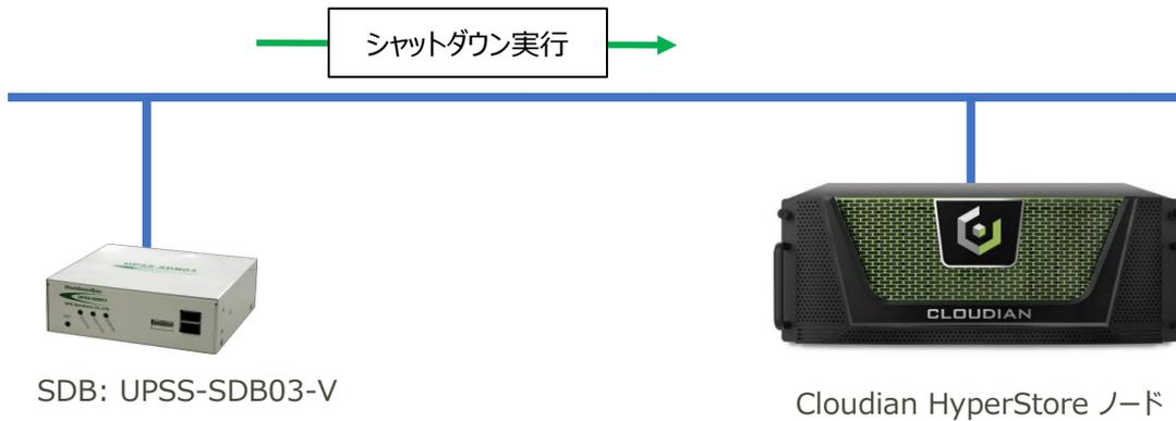
※実際の導入時は SDB が UPS の停電を検知した場合に自動でシャットダウンスクリプトを開始します。
