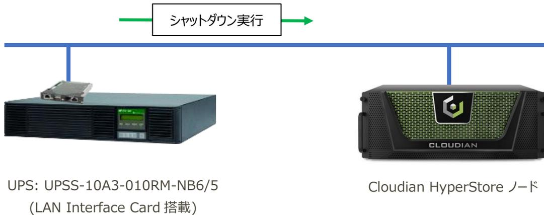
※実際の導入時は UPS が停電を検知した場合に自動でシャットダウンスクリプトを開始します。
