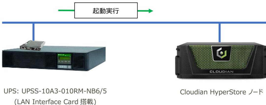
※実際の導入時は復電による UPS 出力再開後自動で起動スクリプトを開始します。
