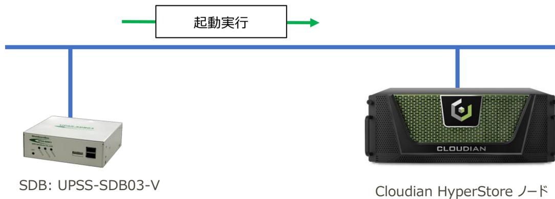
※実際の導入時は UPS の出力開始により SDB も自動起動し、自動で起動スクリプトを開始します。
