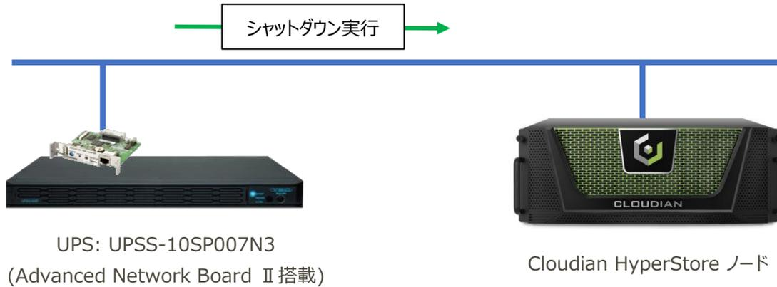
※実際の導入時は UPS が停電を検知した場合に自動でシャットダウンスクリプトを開始します。
