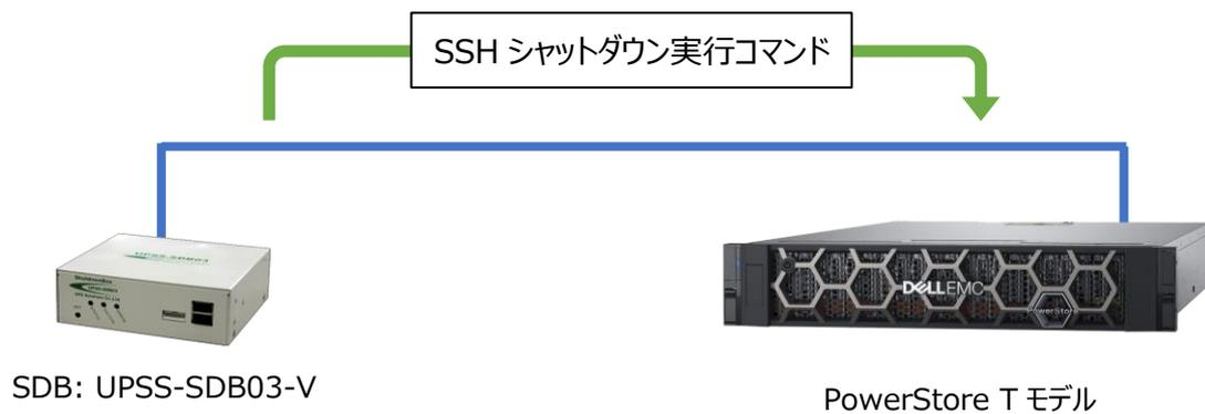
※実際の導入時は、SDB の連携先 UPS が停電した場合に、SDB が UPS の停電を検知することで、SDB がシャットダウンを開始します。
