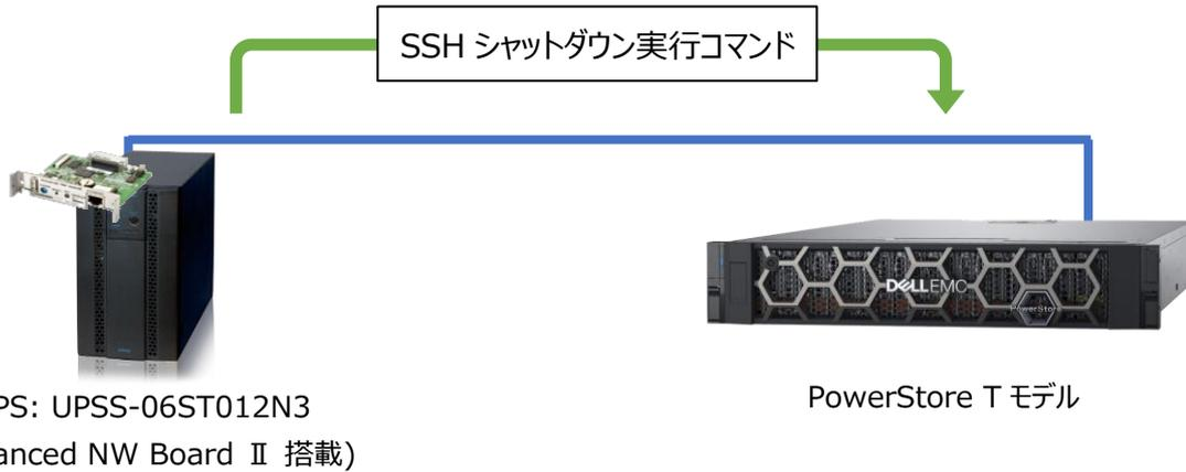
※実際の導入時は、UPS が停電を検知した場合に、UPS が自動でシャットダウンを開始します。
