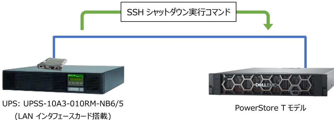
※実際の導入時は、UPS が停電を検知した場合に、UPS が自動でシャットダウンを開始します。
